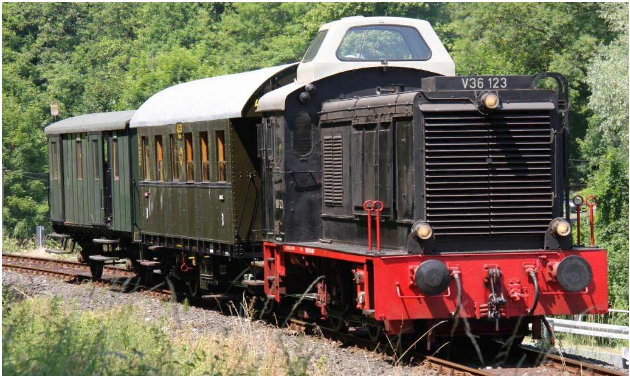
Lok 7 der Eisenbahnfreunde Fränkische Schweiz mit aufgesetztem Führerstand; Foto: DFS
