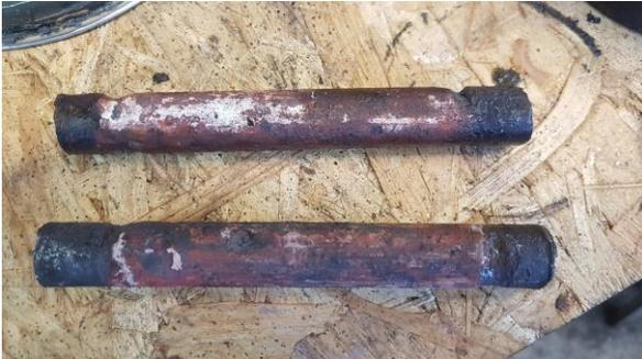
Hier zwei Stehbolzen als Beispiel. Gut zu erkennen sind die Einkerbungen auf beiden Seiten des Bolzens. Hier ist der Stahl angegriffen und würde in absehbarer Zeit im Betrieb undicht werden, da die Bolzen eine Hohlbohrung haben.
